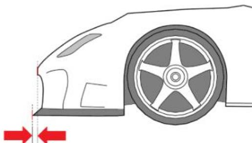
La distancia horizontal máxima, en mm, entre el punto más adelantado de la carrocería y el punto más adelantado del splitter, medida dentro de los 300 mm de la línea central, redondeada al mm más próximo (cero si no hay splitter).
