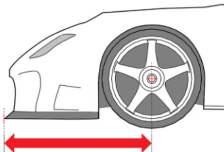
Distancia en el suelo en mm entre el centro del eje delantero y el punto más adelantado del vehículo, redondeada al mm más próximo.
