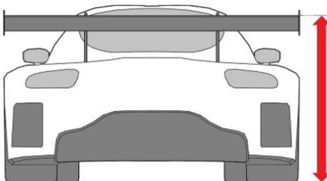
Distancia vertical en mm entre el suelo y el punto más alto del alerón, redondeada al mm más próximo, y sin tener en cuenta ni soportes ni placas laterales (cero significa que no hay alerón trasero).
