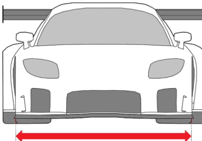
Distancia en el suelo en mm entre los lados exteriores de los dos neumáticos del eje delantero, redondeada al mm más próximo.
